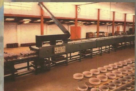
**Car Tunnel Kiln / Fours tunnels à wagonnets.**
